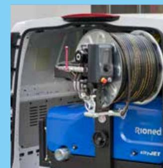
Um 180° schwenkbare Hochdruckhaspel für maximal 140 Meter 1/2" Schlauch
