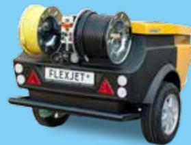
Vielseitige Anhänger, ungebremst mit zulässigem Gesamtgewicht von 750 kg oder gebremst und mit starkem Motor für schwerste Arbeiten ausgerüstet.
