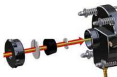
Ermöglicht das Einschleiben einer TV-Kamera durch die Picote Cannon in das Rohr. Beobachten Sie den aufgeblasenen Liner während des gesamten Aushärtungsprozesses!
