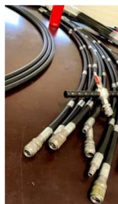
Die flexiblen Schubstangen sind sowohl stark genug zum Schieben und Drehen als auch flexibel genug, um mehrere Bögen zu bewältigen. Dringen Sie weiter vor und verbinden Sie so viele Schubstangen, wie nötig.
